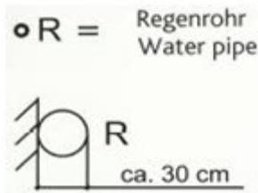
Die Wasserleitungen sind immer an der Säule befestigt. Das Wasserleitungssymbol auf dem Grundriss zeigt nur an, auf welcher Seite des Pfeilers sich die Leitung befindet. Der maximale Abstand vom Hallenpfeiler zur Wasserleitung einschließlich der Befestigungen. Die Befestigungen der Rohre können von Pfeiler zu Pfeiler unterschiedlich sein.
